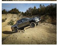
Mit einer Länge von 5.325 mm, einer Breite von 1.900 mm und einer Höhe von 1.815 mm baut der neue Hilux Double Cab Invincible fünf Millimeter kürzer und 45 mm breiter als sein Vorgänger. Je nach Kabinenaufbau misst die Ladeflächenlänge zwischen 1.525 und 2.315 mm. Ob Single Cab, Extra Cab oder Double Cab: Alle Varianten mit Allradantrieb verfügen über eine Nutzlast von einer Tonne sowie eine Anhängelast von 3,5 Tonnen.
